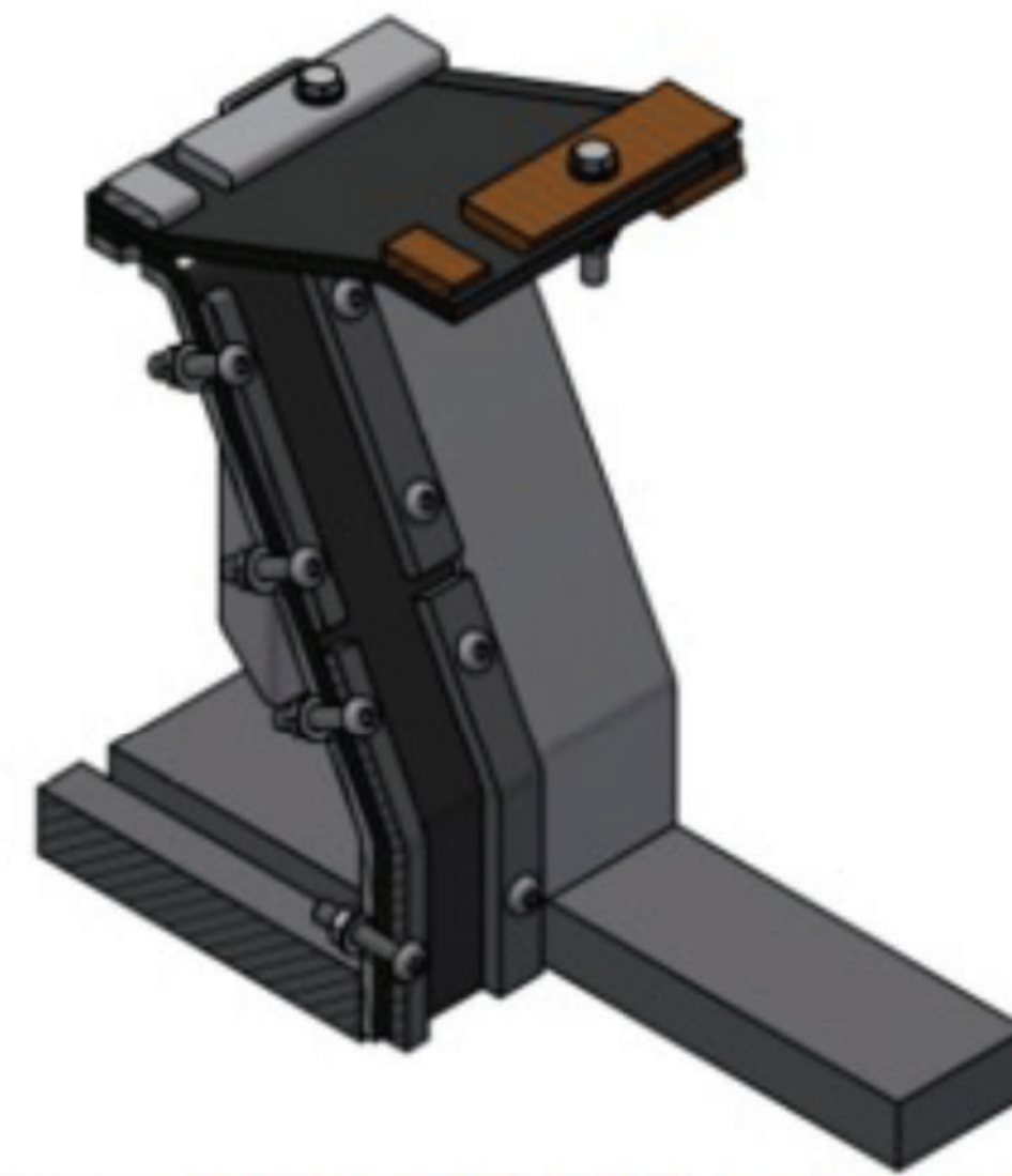
Figuur 6.12: Afdichting scharnierbalk
