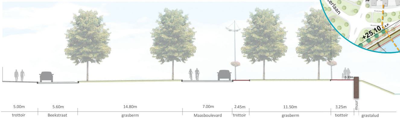
Doorsnede A: bestaande situatie 2024 hoogte muur: 33 cm
