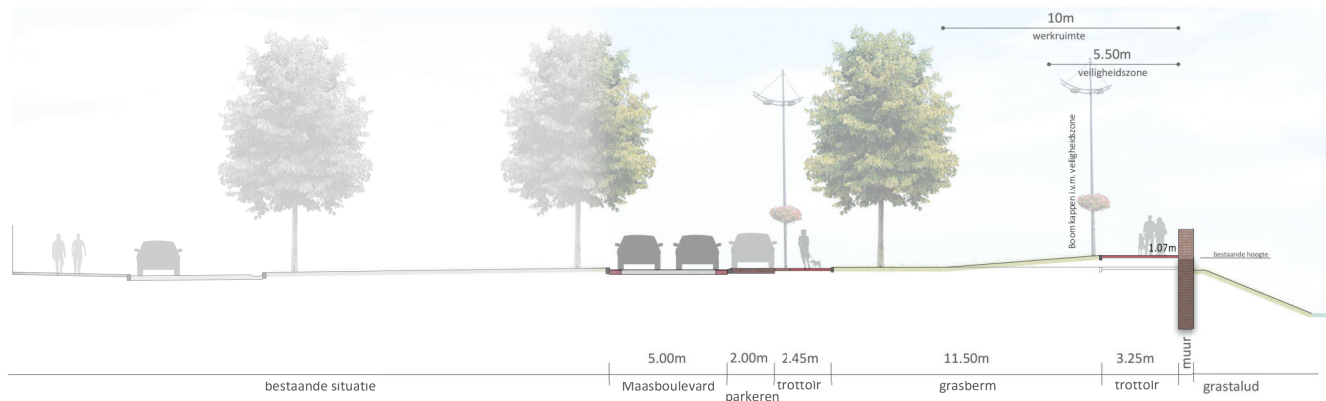
Doorsnede A: situatie zichtjaar 2125 hoogte muur: 107 cm
