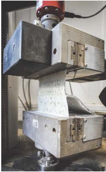
Figuur 5 – Laboratoriumtest verbinding van de geotextiel boven- en onderlaag met zogenaamde pelproeven in trek-apparatuur.
