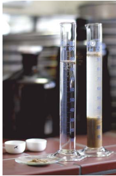
Figuur 6 – Laboratoriumtest zwelvermogenbentoniet met de ‘swell index test’, waarbij 2 gram droog bentoniet binnen 1 dag minimaal dient op te zwellen tot 24 ml.
