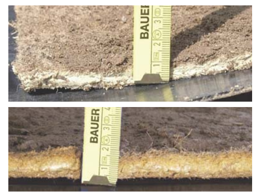
Figuur 16a en b – Detail monstername gehydrateerde bentonietmat bij de Elbe dijk Wittenberge met analyse van mechanisch en fysische veranderingen vanuit BAW Duitsland.
