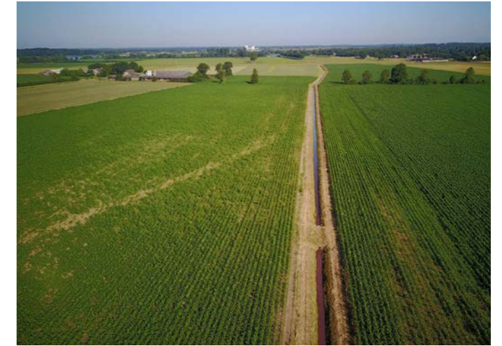
^ Figuur 6 Rechte watergang door het centrale deel van de groene rivier, gericht op drainage van deze van oorsprong vochtige laagte. De rode kleur laat zien dat hier ijzerrijk grondwater uittreedt
