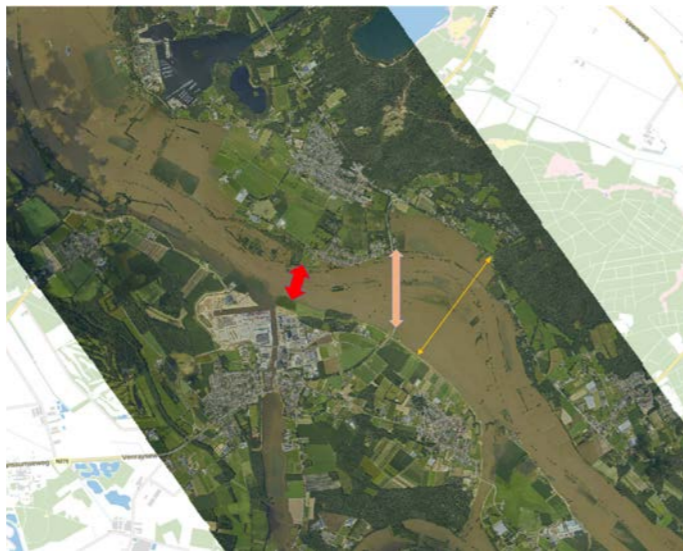
^ Figuur 4 Well tijdens het hoog water van 2021 duidelijk is te zien hoe het Maaswater door de Koninginnebrug en de dijktracees van Well en Wanssum wordt ingesnoerd.
