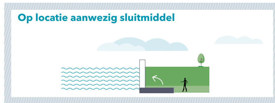
Figuur 14: Schematische weergave van een waterkering met een op locatie aanwezig sluitmiddel.
