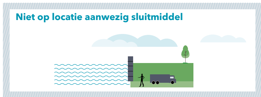
Figuur 15: Schematische weergave van een waterkering met een niet op locatie aanwezig sluitmiddel.
