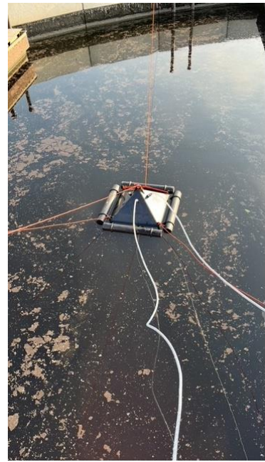
Figuur 43: gaskap voor gasmonsters op wateroppervlak van de Nereda in Panheel
